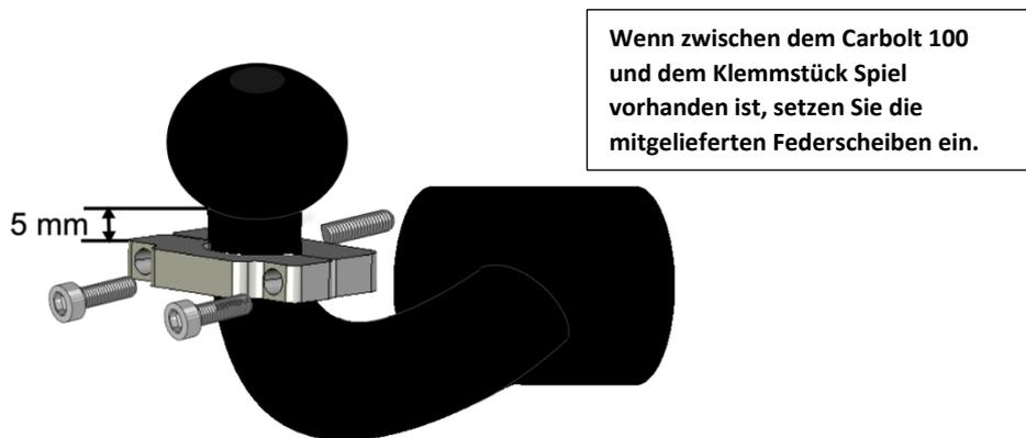
2. Ziehen Sie die Inbusschrauben fest an und achten Sie darauf, dass das Klemmstück in einer Linie mit dem Fahrzeug liegt.
